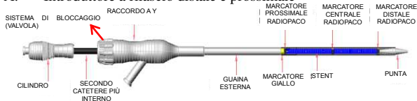
Figura 2. Introduttore (a rilascio distale e prossimale)
